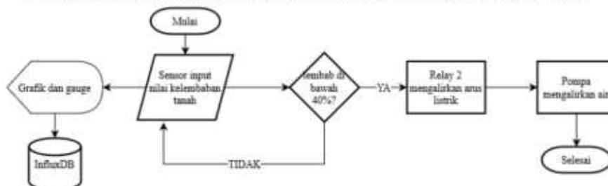
**Gambar 4. Flowchart monitoring dan controlling berdasarkan sensor kelembapan tanah**
