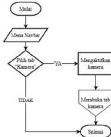
Gambar 6. Flowchart monitoring dari kamera
